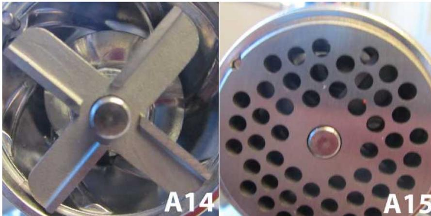
Вставьте шнек в корпус для шнека, потом установите на шейку нож, как показано на рисунке A14, а потом нужный диск с отверстиями, как показано на рисунке A15.
