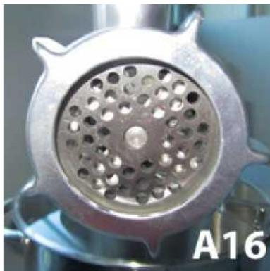
Установите фиксирующее кольцо / накидную гайку и прочно закрутите его по часовой стрелке (рисунок A16).
