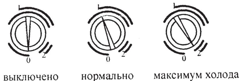
Рисунок 3 – Установка температуры в камере
