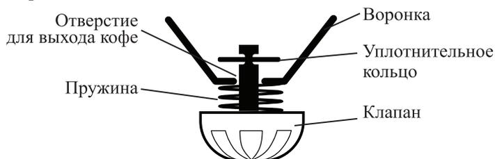
Когда вы устанавливаете кофейник на платформу с подогревом, крышка кофейника приподнимает клапан. Вместе с клапаном поднимается уплотнительное кольцо внутри воронки и открывает отверстие для выхода кофе. Когда вы вынимаете кофейник, пружина выталкивает клапан вниз и уплотнительное кольцо плотно закрывает отверстие для выхода кофе. Таким образом, когда вы вынимаете кофейник, подача кофе приостанавливается, а когда устанавливаете кофейник обратно, подача кофе возобновляется.
