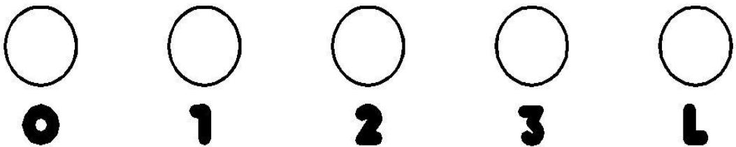
Работа вытяжки контролируется при помощи совместного переключателя
