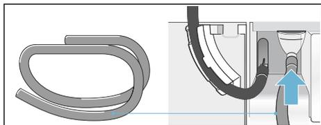
5. Зафиксируйте шланг слива воды с другой стороны в зависимости от подключения А, В или С.
