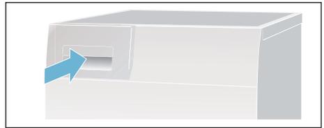
**Указание:** Благодаря фильтру в резервуаре для конденсата выполняется фильтрация конденсата, используемого для автоматической очистки сушильной машины. Фильтр очищается за счёт опорожнения резервуара для конденсата. Тем не менее, фильтр необходимо периодически проверять на отсутствие оставшихся отложений и, при необходимости, удалять их. См. → Страница 37.
