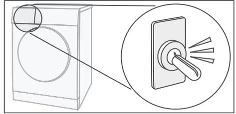
Конденсат закачивается в резервуар при помощи насоса, что сопровождается характерными звуками.
