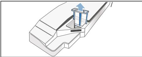
4. Промойте фильтр под тёплой проточной водой или в посудомоечной машине.
