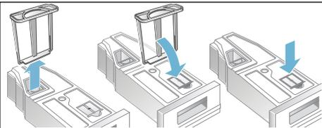
9. Вставьте резервуар для конденсата в сушильную машину до фиксации со щелчком.
