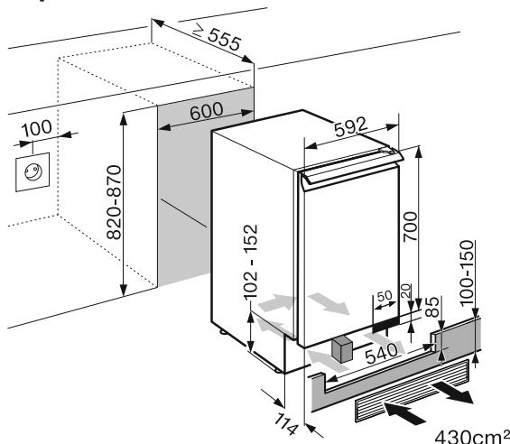
Перед встраиванием обратите внимание на то, чтобы ниша для встраивания точно соответствовала заданным размерам. Обязательно придерживайтесь размеров вентиляционных отверстий. Вырез в цокольной панели для прилагаемой вентиляционной решетки должен быть отцентрирован с прибором, чтобы обеспечить правильную работу прибора.
