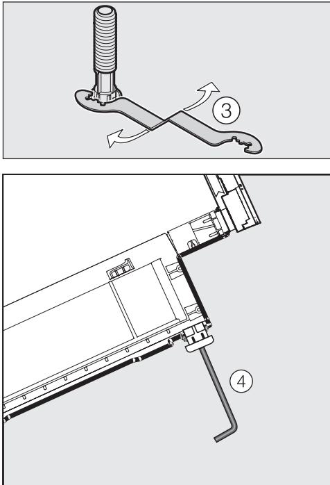
Вы можете выворачивать ножки или с помощью прилагаемого гаечного ключа (3), или с помощью торцового шестигранного ключа (4).
