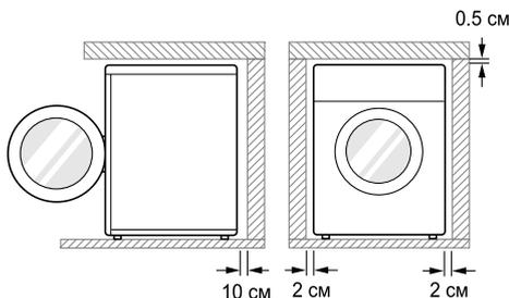
**Ровный пол:** допустимый уклон пола под всей занимаемой машиной площадью не должен превышать  $1^\circ$ .
