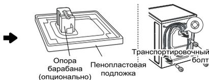
Снимите транспортировочные болты и опоры.
