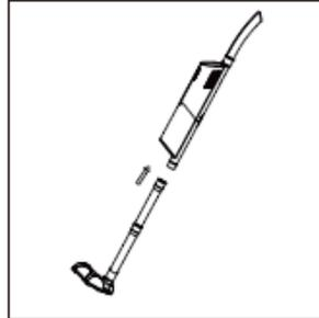
3. Выровняйте трубку с насадкой относительно корпуса так, чтобы основная часть насадки располагалась со стороны переключателя питания, и наденьте широкий конец удлинительной трубки на воздухозаборную трубку корпуса до фиксации.
