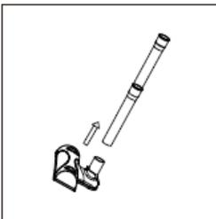
2. Вставьте узкий конец удлинительной трубки в отверстие насадки-щеткой для уборки пола и ковров и прижмите до фиксации.
