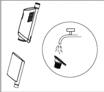
Отсоедините от корпуса пылесоса контейнер для сбора пыли с HEPA-фильтром и вытряхните пыль. Промойте контейнер и HEPA-фильтр прохладной водой, затем дайте им полностью высохнуть естественным образом. Установите HEPA-фильтр обратно в контейнер, а контейнер присоедините к корпусу пылесоса.
