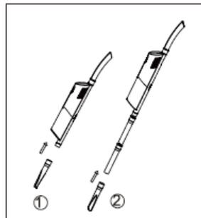
Для компактного использования вы можете надеть щелевую насадку для уборки труднодоступных мест непосредственно на воздухозаборную трубку пылесоса (1) и использовать пылесос как ручной. Или вы можете надеть эту насадку на удлинительную трубку вместо насадки-щетки для уборки пола и ковров (2) и использовать пылесос как вертикальный.
