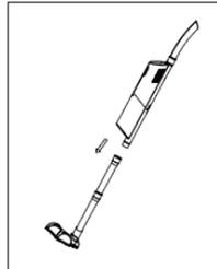
4. Чтобы отсоединить удлинительную трубку от корпуса пылесоса, потяните за нее вниз.
