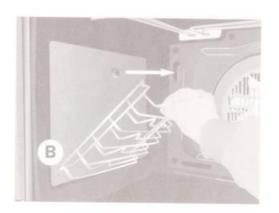
Для установки телескопических направляющих для противня Вы должны проделать те же шаги, но в обратном порядке (C).
