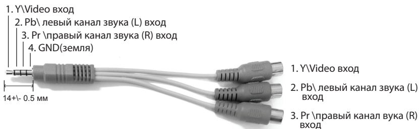
Рис.1 Адаптер подключения изображения или звука режимов AV \YPbPr *
