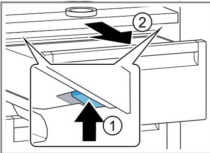
4. Приподнимите и извлеките разделительную полку движением в сторону.
