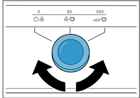
Установка влажности воздуха с помощью регулятора влажности в боксе для овощей и фруктов в зависимости от вида и количества загружаемых продуктов:
