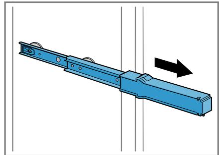
2. Сдвиньте фиксатор в направлении стрелки ① и ослабьте задние штифты ②.
