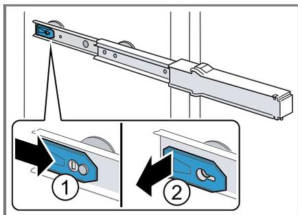
2. Установите направляющую на задние штифты ① и передвиньте фиксатор назад ②.
