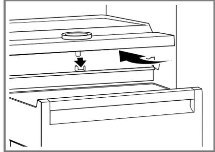
3. Установите стеклянную пластину на разделительную полку.
