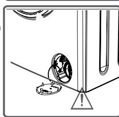
На стенках отделений контейнера для моющих средств со временем могут образоваться твердые отложения. Для очистки этого осадка выньте контейнер для моющих средств. Рекомендуется очищать фильтр насоса раз в два месяца.
