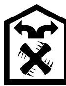
Вытяжка всасывает воздух, который очищается, проходя через жироулавливающие и угольный фильтры, а затем возвращается обратно в кухню.
