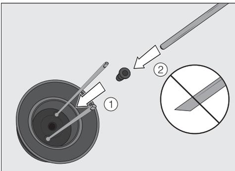
Следите за тем, чтобы **не** вставить скошенный конец стальной трубки в уплотнение. Уплотнение из-за этого повреждается.
