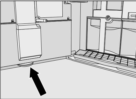
■ Выньте лоток и вымойте его в посудомоечной машине или вручную с помощью теплой воды и небольшого количества моющего средства.
