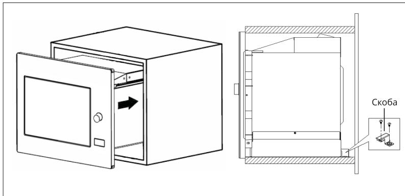
5. Откройте дверцу, прикрепите прибор к шкафу с помощью винта В, затем установите пластиковую крышку в установочное отверстие.
