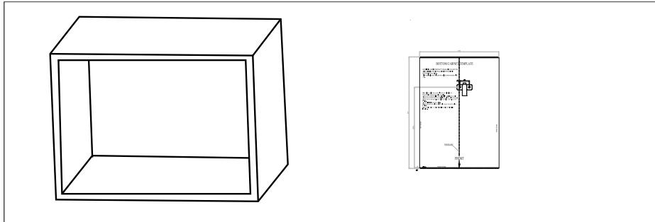
2. Отметьте расположение отверстий на дне шкафа в соответствии с отметками «а» на шаблоне.
