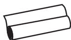
Стрічка для захисту від вологи (1) (для запобігання пошкодженню корпусу під впливом вологи)
