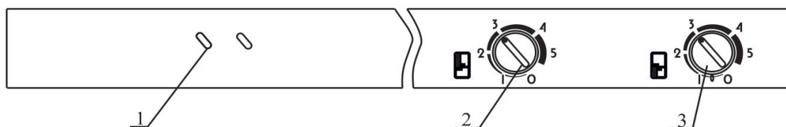
Рис.2 Схема расположения элементов управления и сигнализации 1 – индикаторная лампа (сеть); 2 – ручка терморегулятора верхней камеры морозильника; 3 – ручка терморегулятора нижней камеры морозильника
