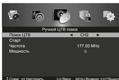
С помощью кнопок ◀▶ на ПДУ вы можете выбрать номер канала для настройки.
