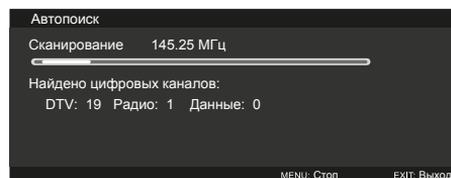
Вначале производится настройка каналов аналогового вещания (для пропуска настройки нажмите кнопку **MENU** на ПДУ или на телевизоре), далее настраиваются каналы цифрового вещания, далее - цифровые радиoproграммы.
