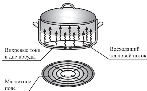
Принцип работы индукционной плиты основан на индукционном нагреве, который представляет из себя нагрев тела в электромагнитном поле за счет теплового действия вихревых электрических токов, протекающих по нагреваемому телу и возбуждаемых в нем благодаря закону электромагнитной индукции.
