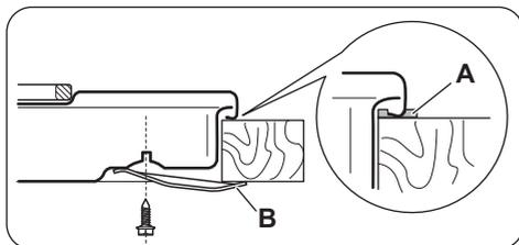
A) идущая в комплекте герметизирующая прокладка
