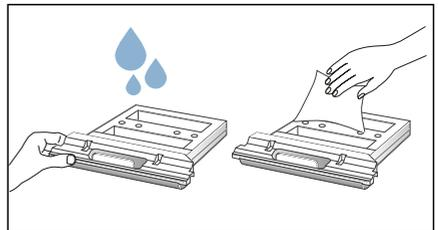
8. Протрите отверстие в приборе мягкой влажной тряпочкой.
