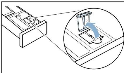
2. Выньте вставленную пробку из углубления резервуара для конденсата.
