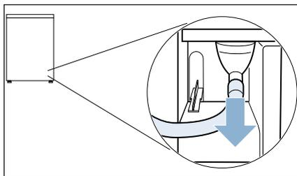
**Указание:** На момент поставки прибора шланг для конденсата закреплен на штуцере.
