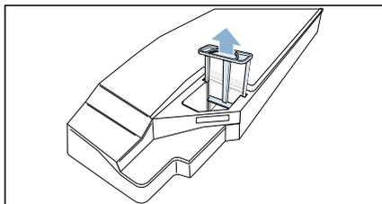
4. Промойте фильтр в проточной воде или в посудомоечной машине.
