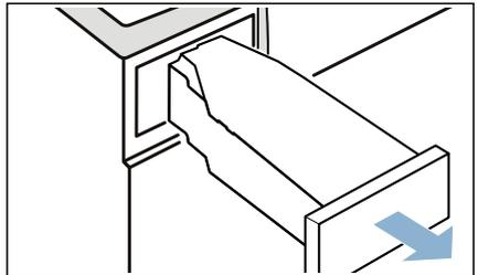
7. Влейте в контейнер для конденсата бутылку оригинального средства для ухода за прибором и прим. 1 ½ л теплой водопроводной воды.
