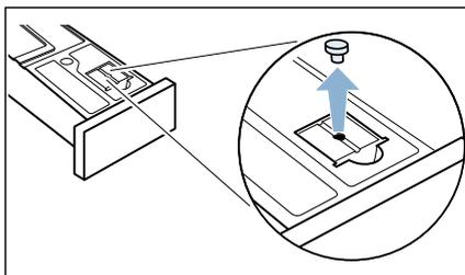
3. Поверните резервуар для конденсата на 180° на нижнюю сторону и удалите вставленную пробку.
