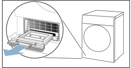
7. Промойте вставку под проточной водой и просушите.
