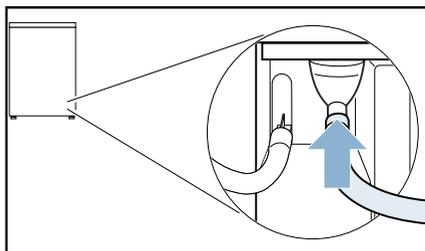
6. Другой конец сливного шланга, в зависимости от варианта подключения, закрепите при помощи соответствующей принадлежности.
