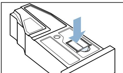
12. Задвиньте резервуар для конденсата до фиксации.
