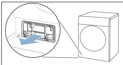
6. Осторожно выньте фильтрующую прокладку из крышки теплообменника.
