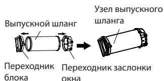
Установка в окне
