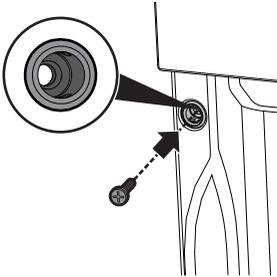
4. Закройте втулки ранее снятыми заглушками.
