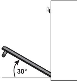
3. Чтобы снова установить дверцу, вставьте шарниры в соответствующие пазы, расположенные на приборе, так чтобы шлицы **A** полностью вошли в пазы. Опустите дверцу вниз, установите ее и извлеките штифты из отверстий петель.
