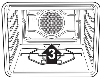
Разместите опорную поверхность для противня пиццы, протолкнув ее до упора в заднюю стенку духовки, а затем опустив ее таким образом, чтобы пластинка нагревательного элемента защелкнулась в основании элемента.
