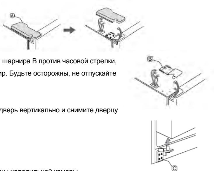
(б). Отвинтите винт шарнира В против часовой стрелки, чтобы снять шарнир. Будьте осторожны, не отпускайте дверь.
