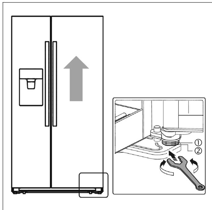
Чтобы поднять дверцу холодильного отделения выше, вращайте гайку (1) против часовой стрелки.
