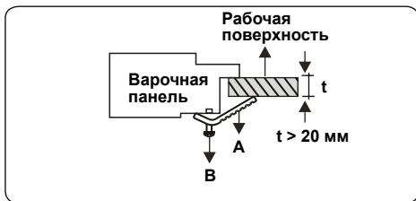
**Важно!** Если прибор устанавливается над шкафом для посуды, необходимо установить разделительную перегородку между основанием прибора и шкафом.
