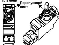
**Клапан без устройства определения пропадания пламени**
