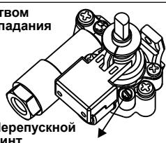
**Клапан с устройством определения пропадания пламени**
