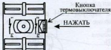
Рисунок 3 - Лицевая панель термовыключателя в моделях 3W30V1, 3W40V1, 3W50V1, 3W60V1
