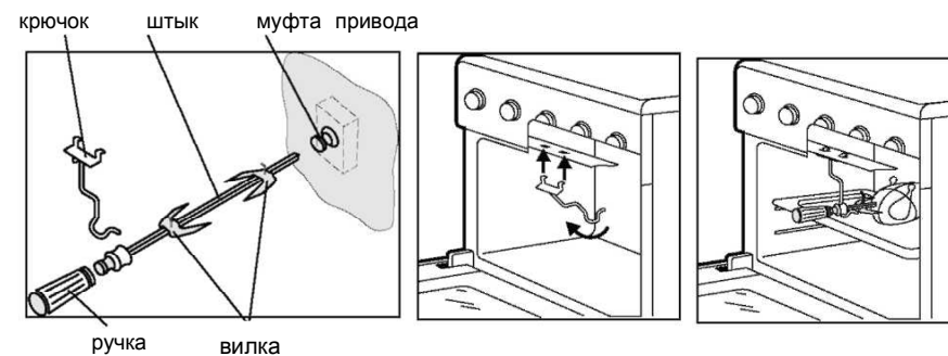
Рисунок 11 – Схема установки вертела
