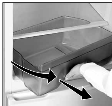
4 rasmi – Idishni sovutgichdan chiqarib olish
